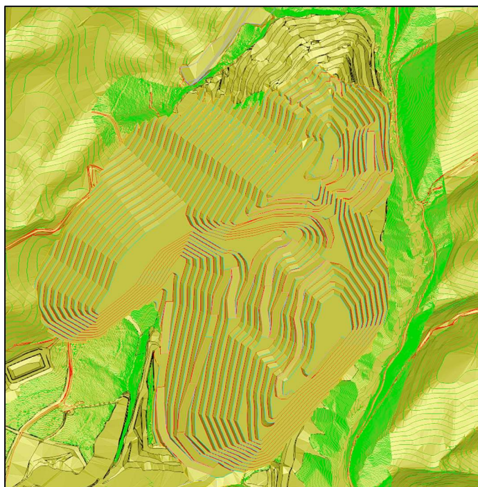
Slika 3.3. 3D prikaz finalne konture kopa
