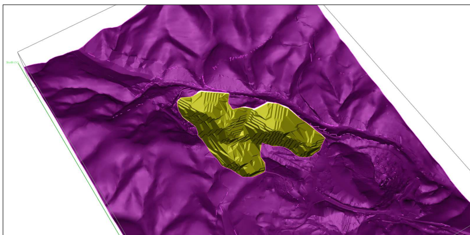
Slika 3.2. Whittle 3D prikaz optimalnog kopa broj 36
